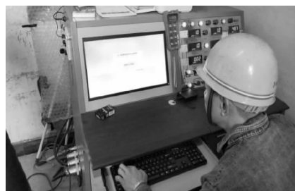
图7 现场数据检测及压力实时数据显示
