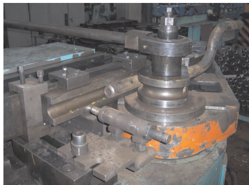
图12 托料装置和滑槽平衡调节装置应用实例
